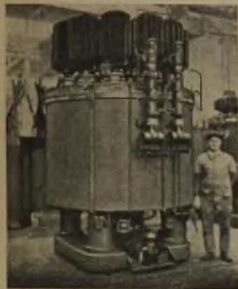
Rys. 45. Prostownik 2 000 A, 600 V w wykonaniu f-my A.C.E. de Jeumont.
