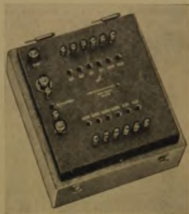
Rys. 2. Kondensator wtyczkowy umieszczony w skrzynce drewnianej.
