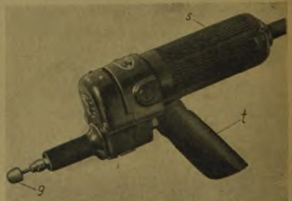
Rys. 14. Szlifierka ręczna napędzana jednofazowym silnikiem zwartym.
