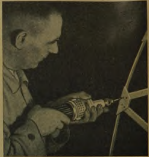
Rys. 13. Wiertarka ręczna podczas pracy.
