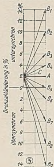
Bild 14. Spannungen der Kommutatorhintermaschine bei verschiedenen Drehzahlen.
