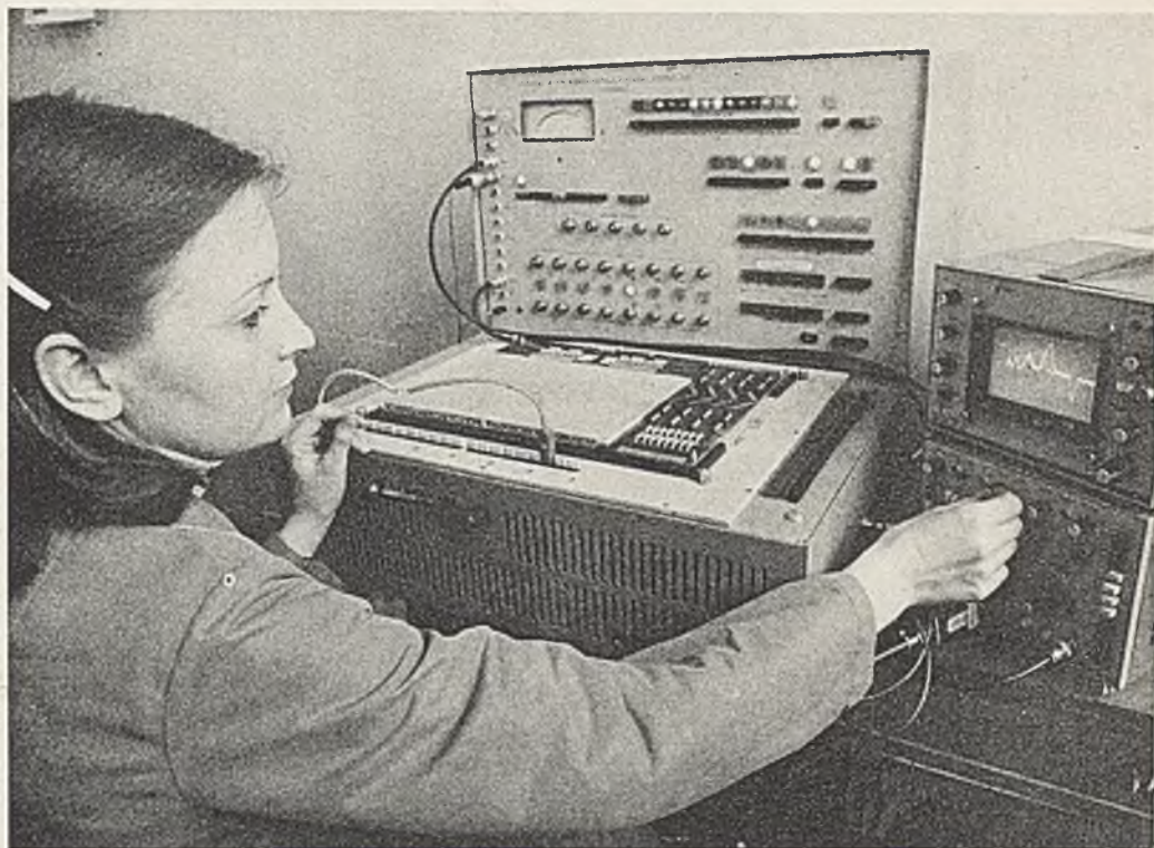
6. Sprawdzanie matrycy pamięci ferrytowej na specjalnym przyrządzie – testerze, który pozwala ocenić każdy z poszytych rdzeni pamięciowych pod względem parametrów technicznych
