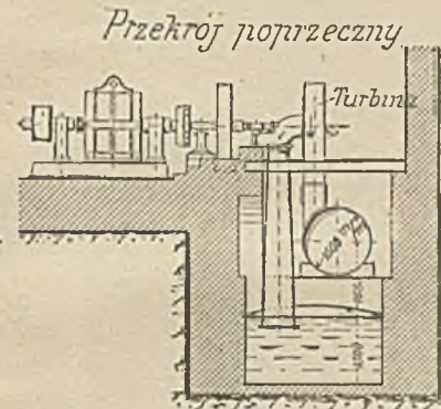
Turbiny spiralne, z rurą tłoczącą i żelaznymi rurami ssącymi, na poziomych wałach, sprzężone z prądnicami.
