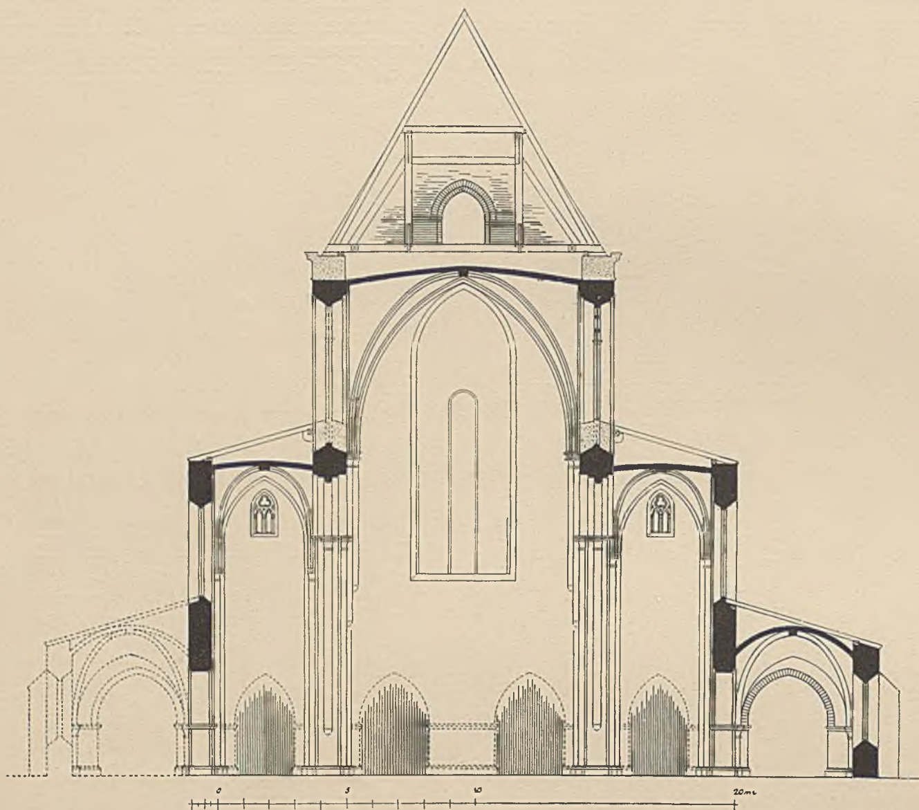
5. Querschnitt durch den Chor der Klosterkirche in Heinrichau, teilweise in Rückbildung.
