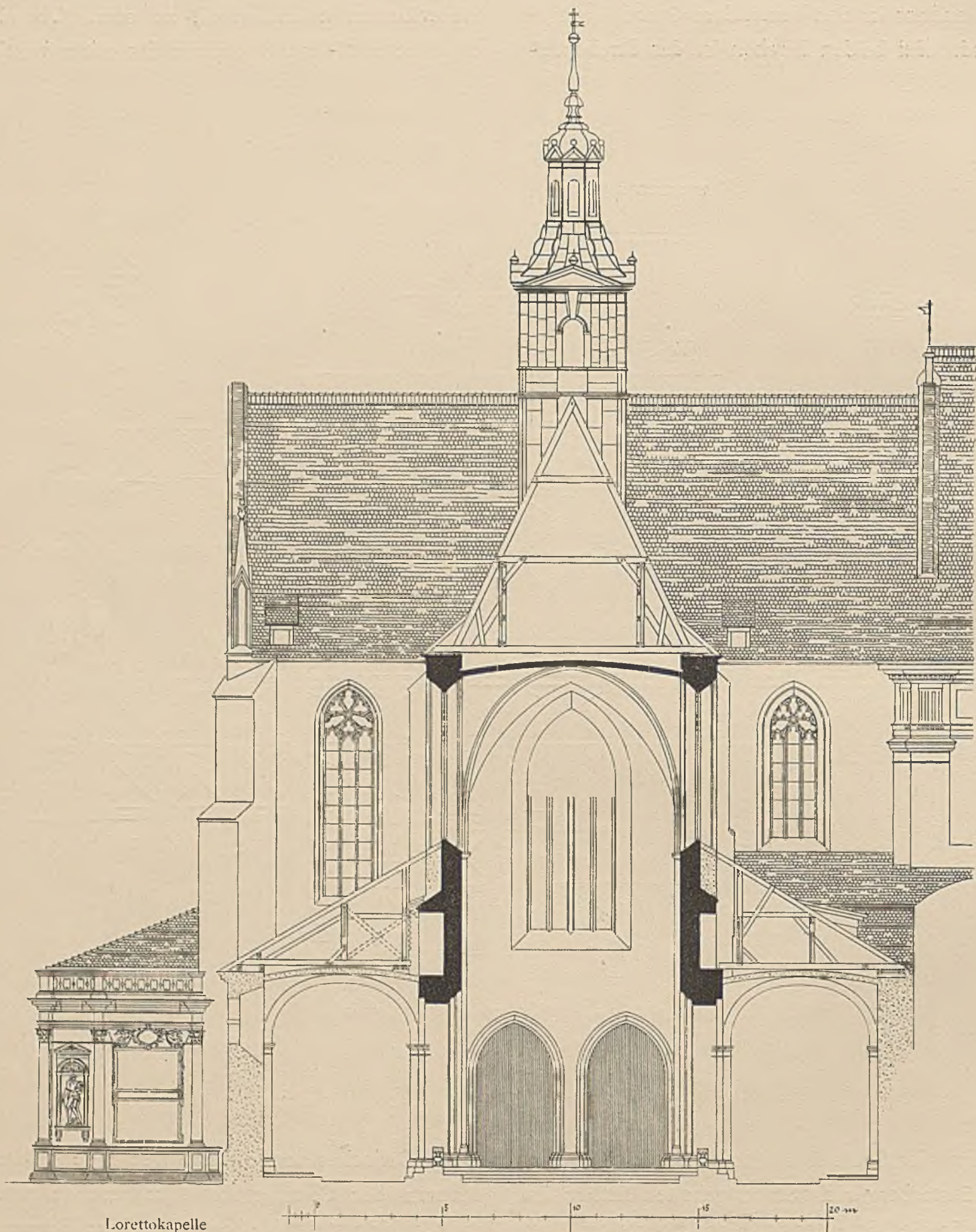
7. Querschnitt durch das Langhaus der Klosterkirche in Lebus.
