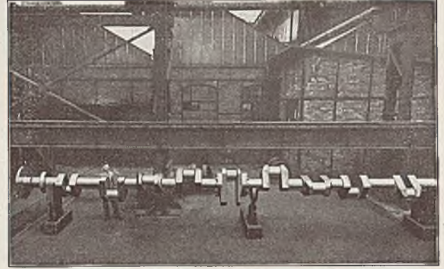
Abb. 75. Schiffskurbelwelle 9fach gekröpft und eine Kompressorwelle für und fertig bearbeitet und geflanscht, Gewicht 9560 kg, Länge 10200 mm, geliefert für Deschimag Weser, Bremen
