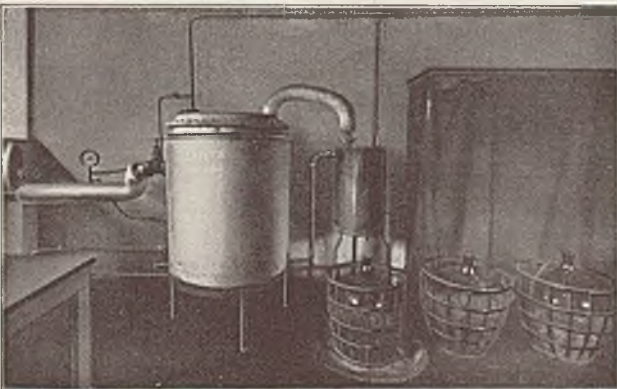
Abb. 100. Apparat zur Herstellung von destilliertem Wasser
