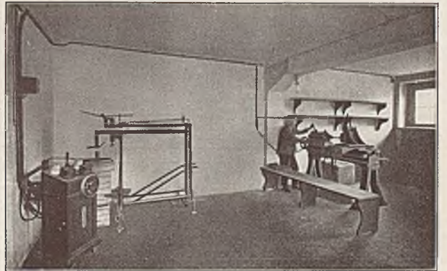
Abb. 99.. Probenvorbereitungsraum und Endellpresse
