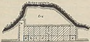
Abb. 6. Verhieb eines Erznestes durch Scheibenbau. Reihenfolge der Scheiben von unten nach oben.
