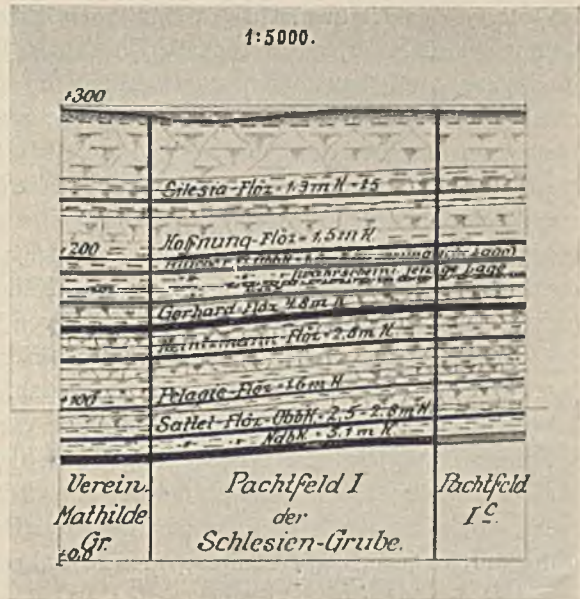
Abb. 10. Profil durch das Abbaufeld I der Mathildegrube.
