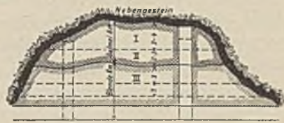
Abb. 7. Verhieb eines Erznestes durch Scheibenbau. Reihenfolge der Scheiben von oben nach unten.
