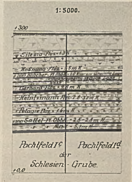
Abb. 11. Profil durch die Abbaufelder I c und I d der Mathildegrube.
