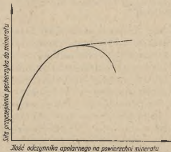
Rys. 3. Podstawowy związek między ilością odczynnika apolarnego znajdującego się na powierzchni minerału i siłą przyczepienia się pęcherzyka do tej powierzchni
