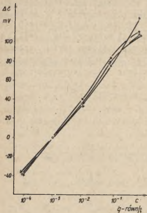
Rys. 3. Zależność zmian potencjału Nernsta na różnych szlifach barytowych od stężenia roztworów KCl
