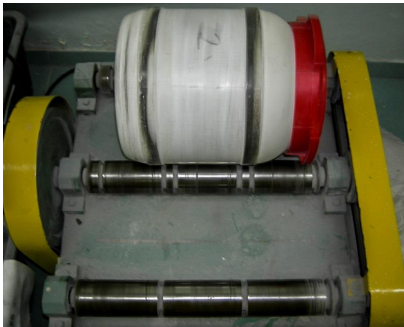
Rys. 32. Mieszalnik do homogenizacji cementów.
