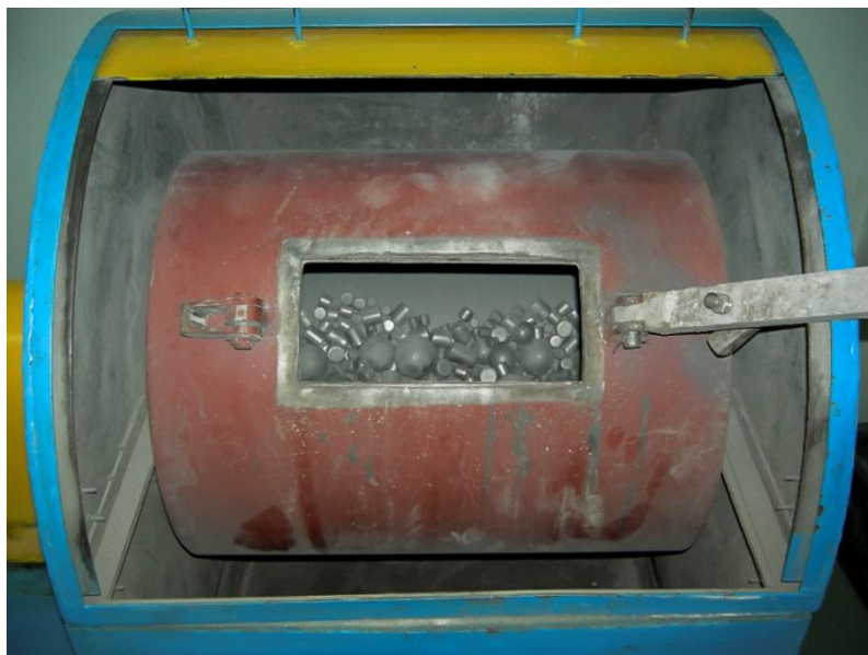
Rys. 33. Laboratoryjny, okresowy młyn kulowy.
