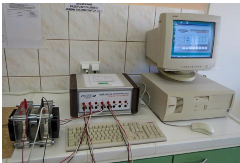
Rys. 38. Aparat do pomiaru przepuszczalności jonów \text{Cl}^- .
