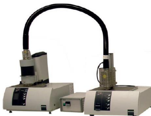
Rys. 26. Aparat STA 409EP firmy Netzsch do różnicowej analizy termicznej DTA z termogravimetrią TG.
