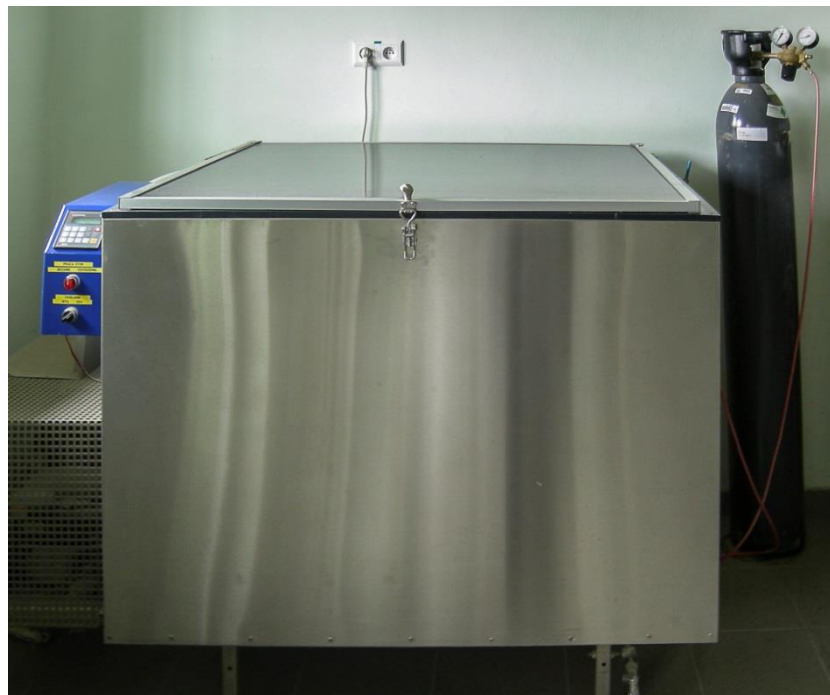
Rys. 55. Komora do wykonywania badań przyspieszonej karbonatyzacji.
