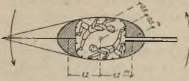
Ryc. 53. Sposób odwrócenia pocisku międzyplanetarnego o 180°.
