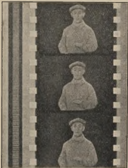
Ryc. 146. Film, zdejmovany metodą „trierton“. Zdjęcie dźwięków widoczne na lewym brzegu filmu.
