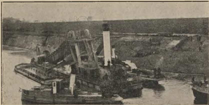
Ryc. 208. Draga czerpakowa „Krab“ (dawniej „Venezia“), zakupiona w Anglii — podczas pracy. Z lewej strony szalanda, napełniona piaskiem, i holownik, holujący próżną szalandę do wymiany.
