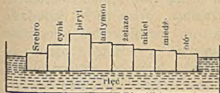
Ryc. 87. Słupy z metali, o tych samych podstawach, a wysokości odwrotnie proporcjonalnej do ich ciężaru gatunkowego, posiadają równe masy; wskutek tego zanurzają się w ręci, na zasadzie prawa Archimedesa, do tej samej głębokości. Wyobrażają nam one stan równowagi w skorupie ziemskiej. Głębokość, do której się zanurzają, to płaszczyzna izostatyczna.
