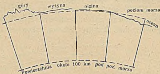
Ryc. 86. Poszczególne słupy skorupy ziemskiej mają ten sam przekrój u podstawy, te same masy (ciężary), a różną objętość i gęstość (ciężar gatunkowy). Im wyższy słup, tem mniejsza jego gęstość. Głębokość 100 km — to powierzchnia kompensacji izostatycznej.
