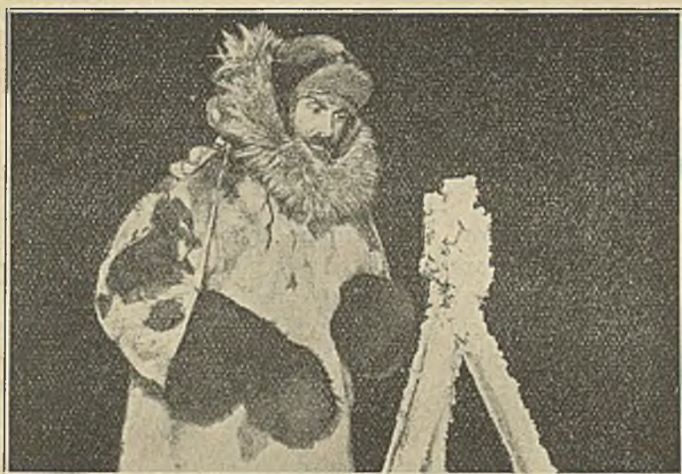
Ryc. 173. Teodolit Dr. Larry'ego Gould'a, kierownika prac geologicznych wyprawy, pokrywal się lodem, co utrudniało robienie pomiarów.
