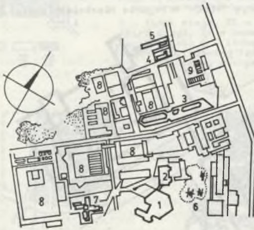
Rys. 1. Obiekty socjalne w zakładach firmy Olivetti & Co w Ivree Włochy 1 - stołówka i warsztat szkolny, 2 - teatr kino, 3 - przychodnia lekarska i biblioteka, 4 - żłobek, przedszkole, 5 - domy robotnicze, 6 - urządzenie sportowe, 7 - ośrodek naukowo-badawczy, 8 - obiekty przemysłowe, 9 - wiaty rowerowe i motocyklowe
