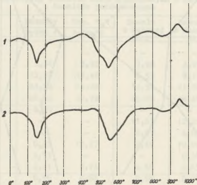
Rys. 3. Krzywe termiczno-różnicowe TAR zwietrzalnych bazaltów 1 - bazalt zwietrzały (próba 3), 2 - bazalt zwietrzały (próba 4)
