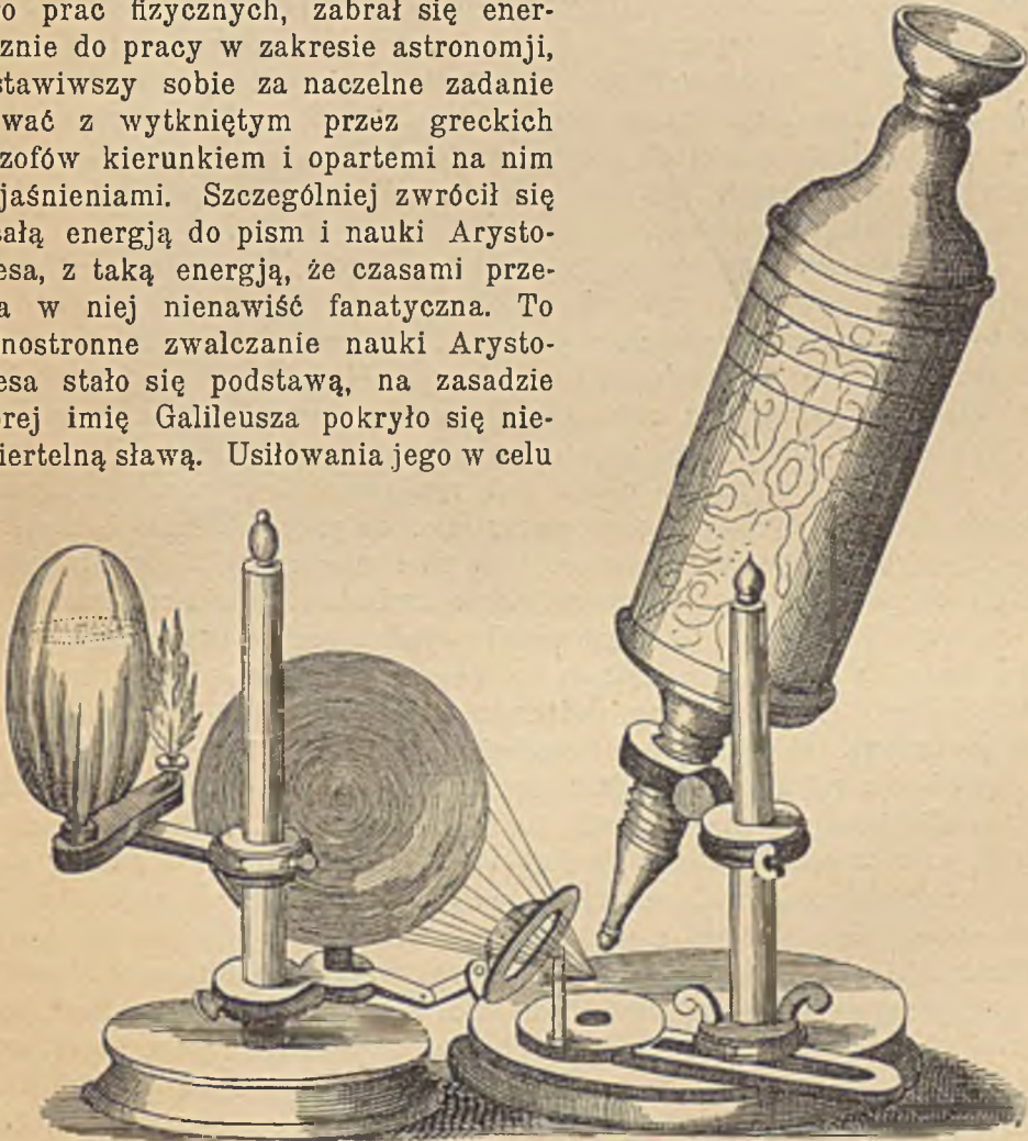
Mikroskop z oświetleniem sztucznem stołu przedmiotowego za pomocą padających promieni światła.
