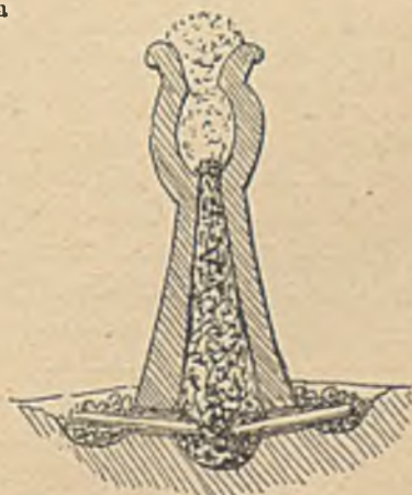
Piec do wytapiania żelaza (Dżur w Afryce).
