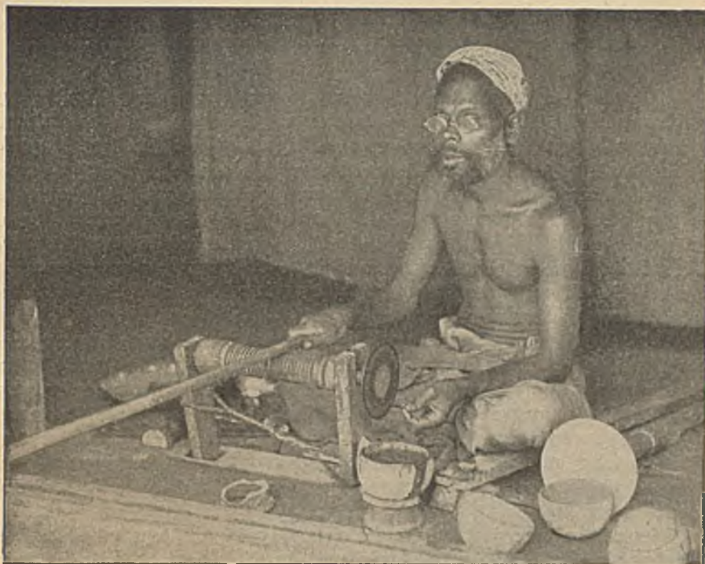
Szlifierz drogich kamieni, pracujący na tokarni pierwotnej.
