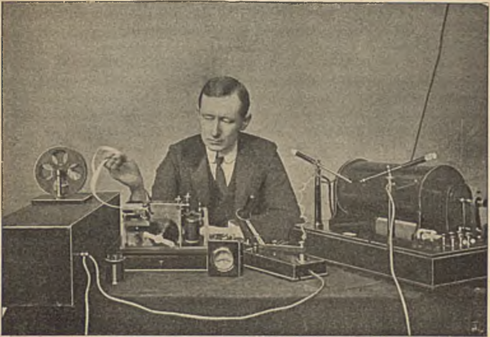
Marconi przy swym przyrządzie odbierającym do telegrafowania bez drutu.
