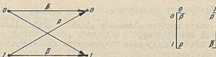
Rys. 3. Opis graficzny i macierzowy binarnego kanału symetrycznego
