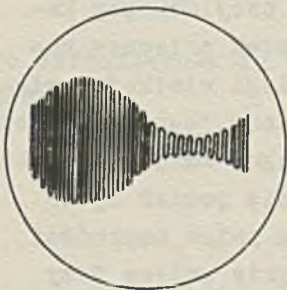
Rys. 3. Oscylogram czasowy drgań modulowanych
