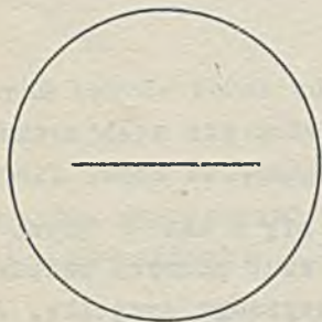
Rys. 5. Oscylogram mostka zrównoważonego
