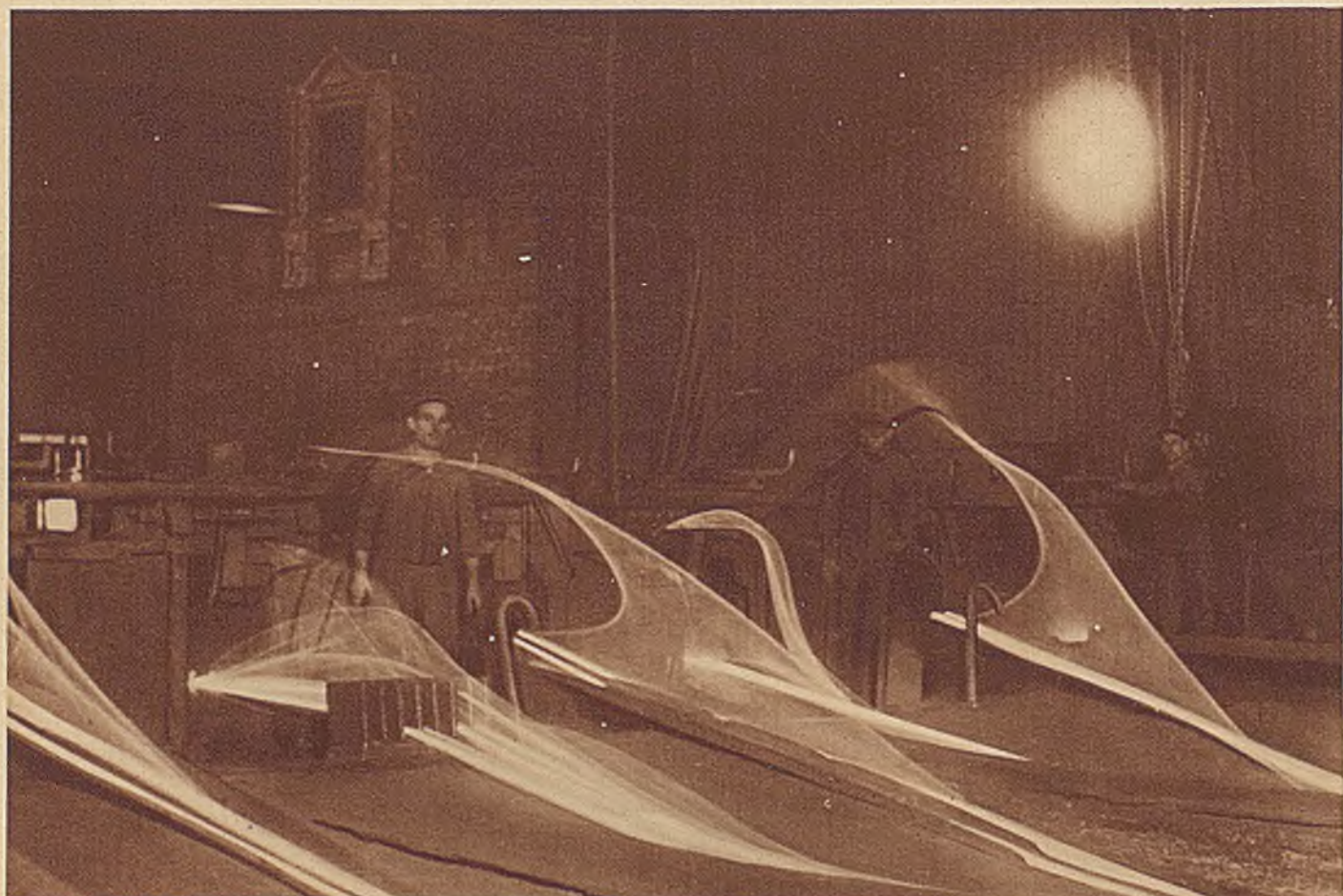
Huta Hantkego w Rakowie pod Częstochową. Walcownia drutu (na lewo coraz mniejsze kalibry).
