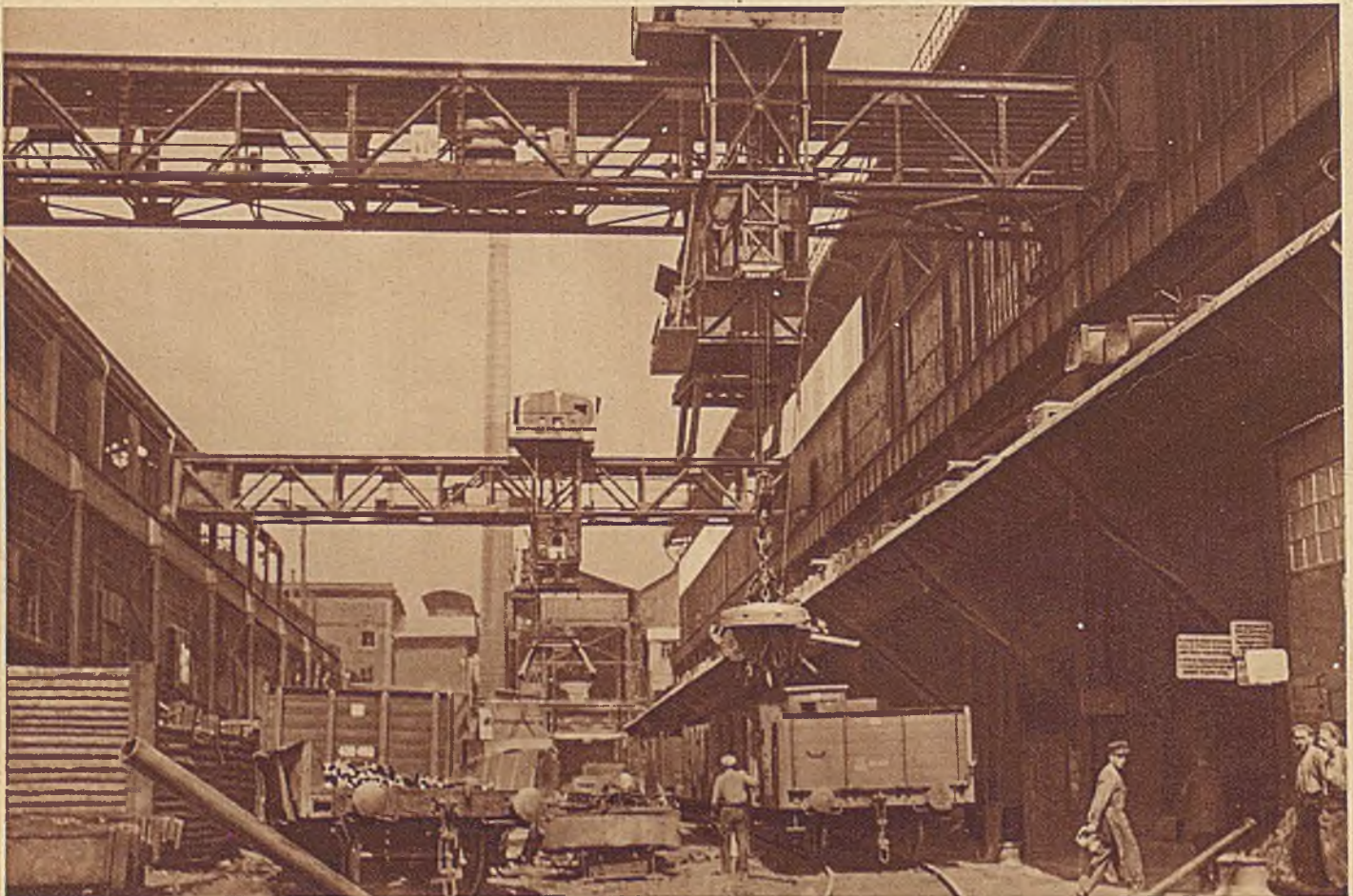
Królewska Huta. Podawanie materiałów do pieców martinowskich za pomocą suwnic zaopatrzonych w uchwyty elektro-magnetyczne zamiast haków.
