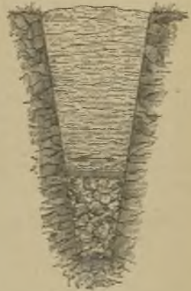
Figur 2. Unterdrain aus Feldsteinen.
