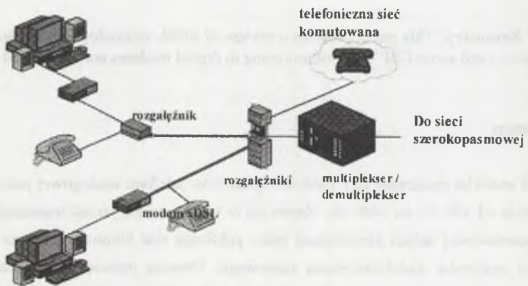
Rys. 1. Architektura systemów xDSL
