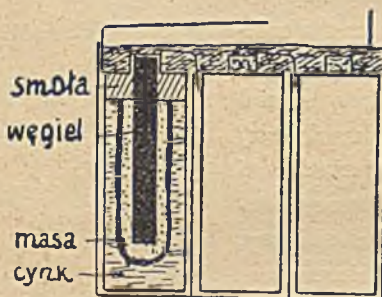
Rys. 10. KIESZONKOWA BATERIA SUCHA W przekroju pokazano jedno tylko ogniwo
