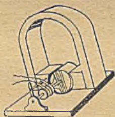
Rys. 17. NAJPROSTSZA POSTAĆ PRĄDNICY NA PRĄD ZMIENNY
