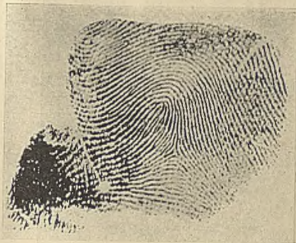
B. ODCISK PALCA PRZEKAZANY FOTOTELEGRAFICZNIE TYM SAMYM SYSTEMEM
