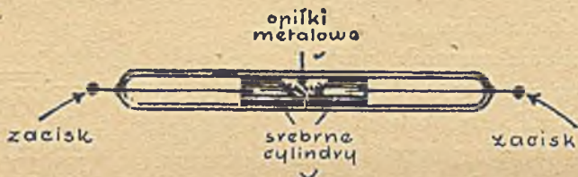
Rys. 62. KOHERER ULEPSZONY PRZEZ MARCONIEGO
