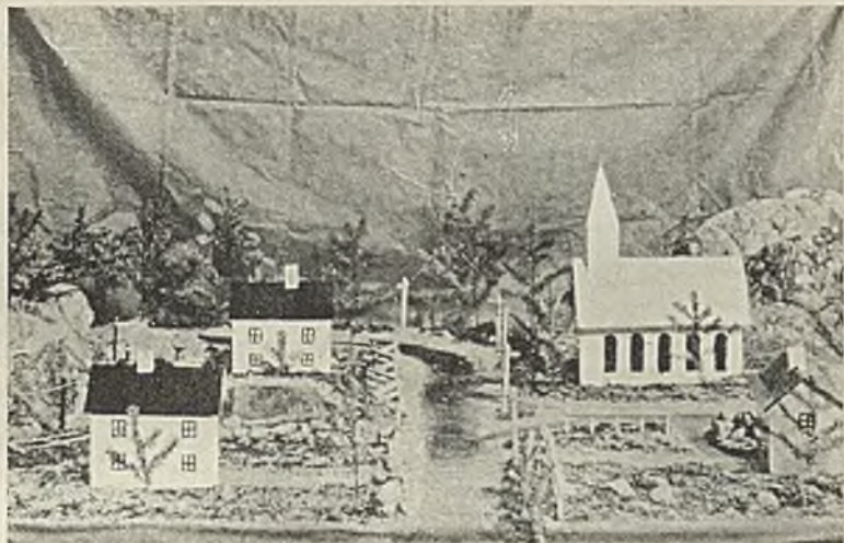
A. MINIATUROWE MIASTECZKO DO DOŚWIADCZEŃ Z SZTUCZNYMI BŁYSKAWICAMI Zawiera on w odpowiedniej skali nawet elektryczną linię przesyłową i tor kolejowy
