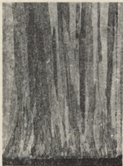
Rys. 4. Struktura kolumnowa ołowiu. Pow. 4 x
