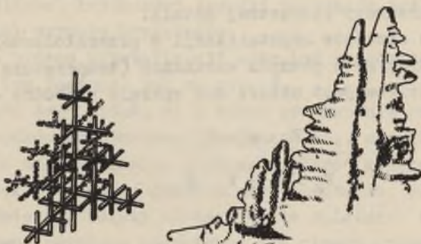
Rys. 1. Schemat budowy oraz fragment dendrytu wg Czernowa
