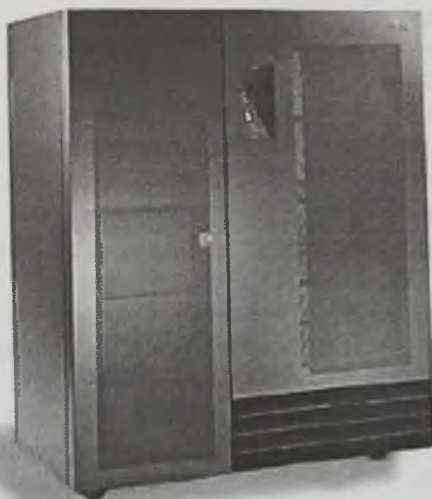
Rys. 1. Macierz dyskowa IBM ESS (SHARK)
