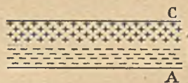
Rys. 15 a. Jeżeli pole jest skierowane od A do C, to warstwy nagromadzonych jonów wytwarzają pole dodatkowe, które odejmuje się od pola podstawowego w okolicy znajdującej się między tymi warstwami, natomiast dodaje się do pola podstawowego w pobliżu elektrod.
