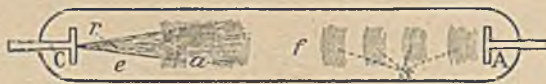
Rys. 25. C — katoda, r — promień katodowy, e — ciemnia Crookesa, a — poświata ujemna, f — ciemnia Faradaya, s — zorza dodatnia, A — anoda.
