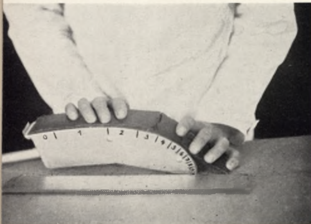
Prüfung der Dehnbarkeit einer Vergußmasse
