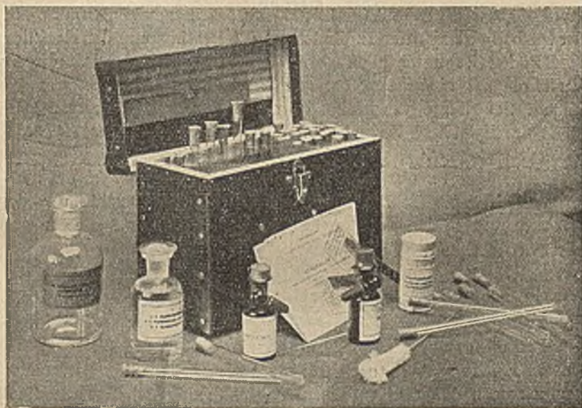
Rys. 20. Reakcjometr dr. St. Kühna do oznaczania stężenia jonów wodorowych w glebie.
