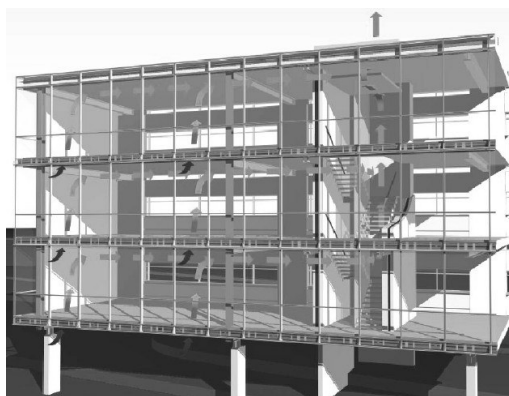
Rys. 6.67. Koncepcja przepływu powietrza wentylacyjnego w budynku B&O
