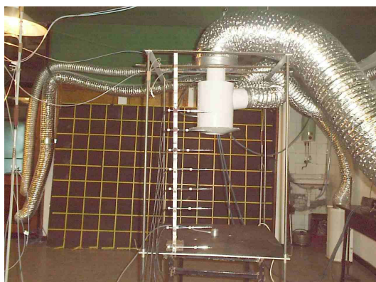
Rys. 6.44. Sondy pomiarowe 8-kanalowego termoanemometru do pomiaru prędkości i temperatury powietrza
