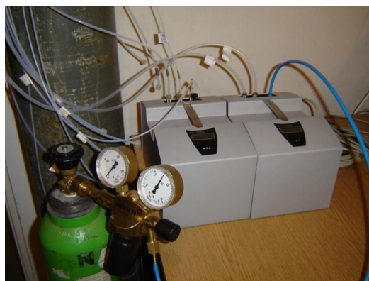
Rys. 6.45. Układ do dozowania i pomiaru stężenia gazu znacznikowego
