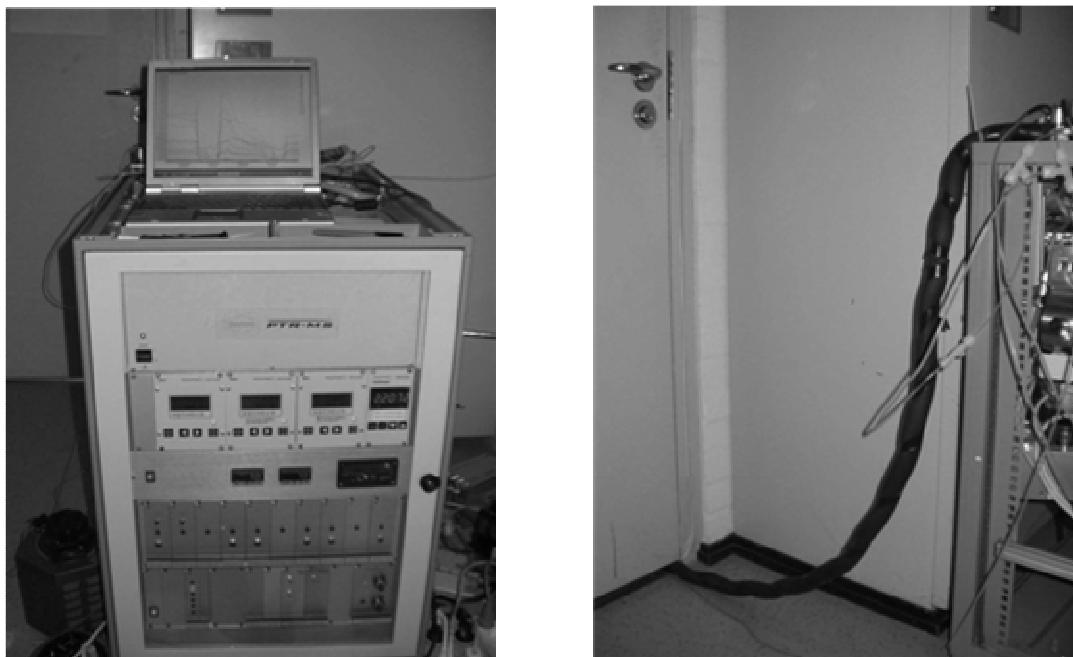
Rys. 8.13. Instrument PTR-MS oraz próbkowanie powietrza wewnętrznego
