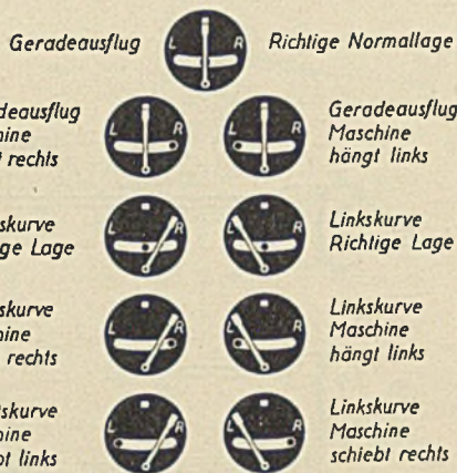
Abb. 32. Anzeige des Wendezigers in verschiedenen Flugzuständen (Askania-Werke A.-G.)
