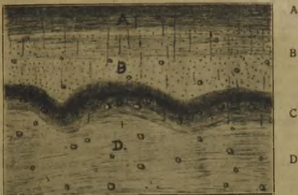
Ryc. 5. Profil normalny gleby (ortsztajnowej) rudawcowej. (według Emeis'a). A — piasek próchniczny; B — piasek zbielicowany; C — rudawiec; D — podłoże
