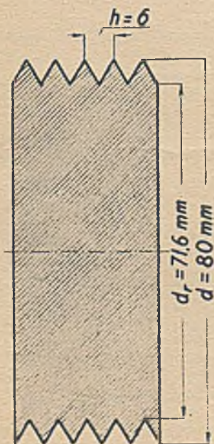
Rys. 10. Przekrój śruby z gwintem metrycznym.
