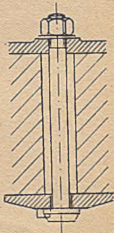
Rys. 27. Śruba fundamentowa z płytą.
