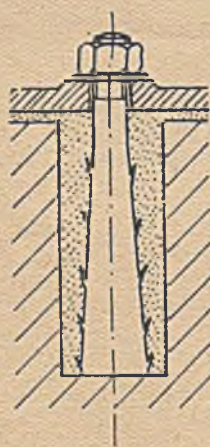
Rys. 26. Śruba fundamentowa z zadrąmi.
