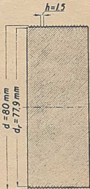
Rys. 11. Przekrój śruby z gwintem drobnozwojowym.
