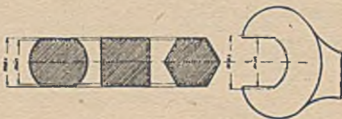
Rys. 53. Rozwartość klucza i szerokość nakrętki lub łba.
