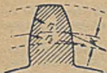
Rys. 91. Budowa zęba o profilu ewolwentowym.
