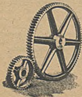
Rys. 89. Koła zębate czołowe.
