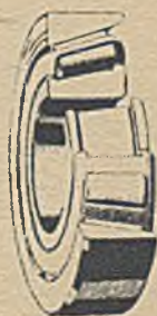
Rys. 44. Łożysko rolkowe jednorzędowe stożkowe.
