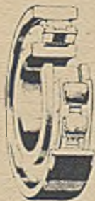
Rys. 43. Łożysko rolkowe jednorzędowe cylindryczne.
