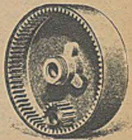
Rys. 93. Koło o zazębieniu wewnętrznym.
