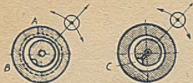
Rys. 28. Smarowanie czopów pod obciążeniem zmiennym.
