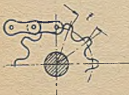
Rys. 84. Napęd łańcuchem rolkowym. Rys. 85. Napęd łańcuchem zębatym.
