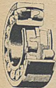
Rys. 42. Łożysko rolkowe dwurzędowe wahliwe.
