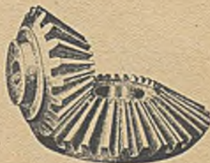
Rys. 100. Koła zębate stożkowe.
