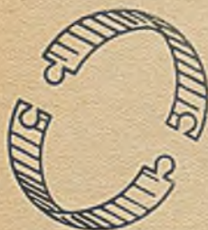
Rys. 34. Zamki w obrączce smarującej.
