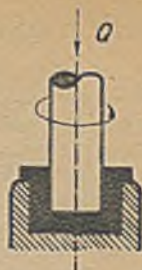
Rys. 13. Walek w łożysku oporowym.
