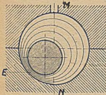
Rys. 26. Czop „pływa” w łożysku.
