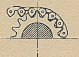
Rys. 84. Napęd łańcuchem rolkowym. Rys. 85. Napęd łańcuchem zębatym.
