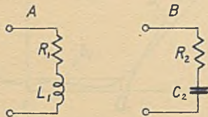
Rys. 5. Dwojniki A i B są sprzężone dla częstości f = \frac{1}{2\pi\sqrt{L_1 C_2}} , gdy R_1 = R_2 .
