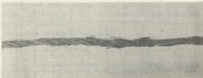
Rys. 5. Odcinek zmęczonej liny \varnothing 18 mm, konstrukcji 6x19 + R_0
