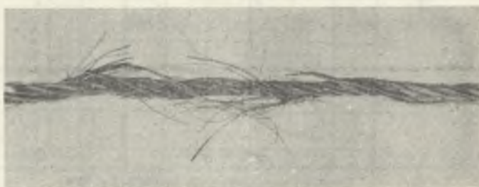
Rys. 6. Odcinek zmęczonej liny \varnothing 18 mm, konstrukcji 7 x 19
