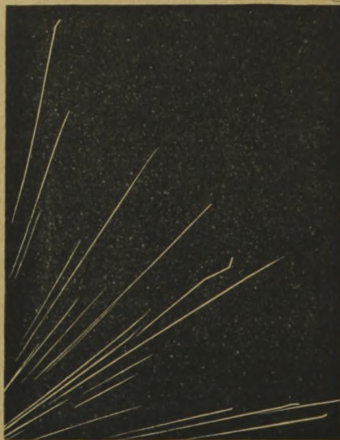
Rys. 126. — Uwidocznienie przebiegu \alpha -cząstek w powietrzu przesyconem parą wodną, według Wilsona .
