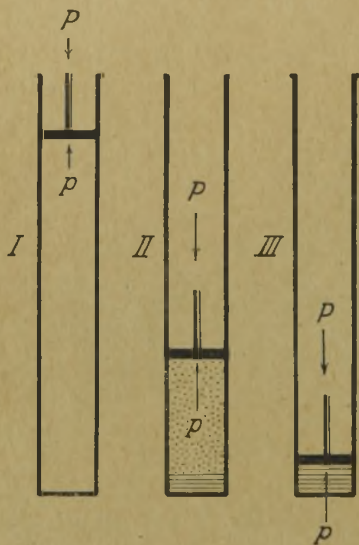
Rys. 10. Skraplanie gazu w stałej temp: I — stan pary nienasyconej (1 faza gazowa); II — stan pary nasyconej i cieczy (2 fazy: gazowa i ciepla); III — stan samej tylko cieczy (1 faza ciepla).
