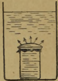
Rys. 21. Ciśnienie osmotyczne roztworu cukru zamkniętego błoną pęcherza rozdyma tę błonę.
