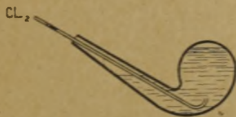
Rys. 55. Otrzymywanie wody chlorowej: gazowy chlor Cl_2 wprowadza się rurką do odwróconej retorty z wodą.
