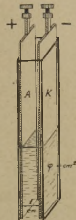
Rys. 69. Przewodnictwo gramorównoważnikowe wykaże roztwór o stężeniu \eta = 1 grówn. użyty w rozcieńczeniu \varphi cm 3 , jeśli zmierzmy je w naczyniu prostopadłościennym pomiędzy elektrodami A i K w odstępnie 1 cm.
