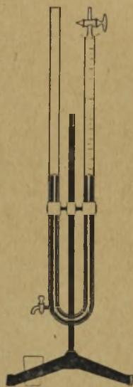
Rys. 43. Eudiometr Hofmanna z iskiernikiem do zapalania mieszanin gazowych.
