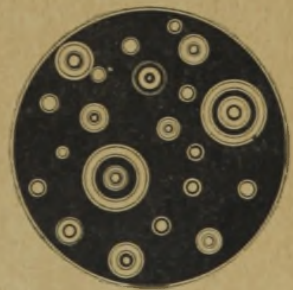
Rys. 28. Obraz koloidalnego roztworu, rozpatrywanego przez ultramikroskop: ilość świecących kółek odpowiada ilości rozpraszających światło cząstek.
