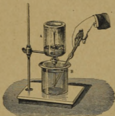
Rys. 92. Rozpuszczalność NH_3 w wodzie. do flaszki A wypełnionej amonjakiem i opatrzonej szczelną zatyczką z rurką, po odłamaniu końca rurki, woda wpada, jak do próżni.
