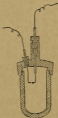
Rys. 34. Bomba kalorymetryczna wyobrażona w przekroju.
