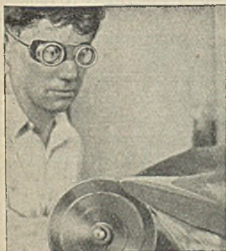
Rys. 61. Szlifowanie świdra z nie-nakładanej strony. Strona napawana nie potrzebuje być szlifowana, jednak czasami szlifuje się również warstwę napawaną, aby ułatwić pracę świdra.
