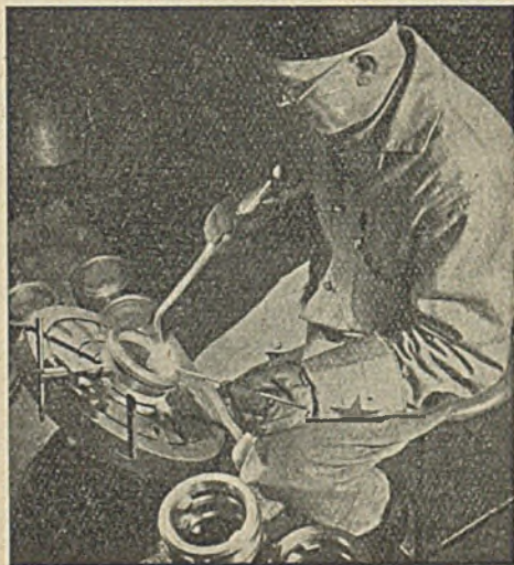
Rys. 12. Nakładanie twardym metalem gniazd zaworowych, wykonywane w specjalnym przyrządzie.
