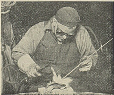
Rys. 102. Napawanie warstwy twardego metalu, z wtrąconymi ziarnami Hay-stellitu na podszewie ogona samolotu.
