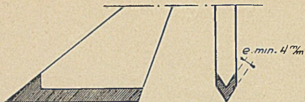
Rys. 31. Napawanie Alchromem lemiesza pługa metodą acetylenową.
