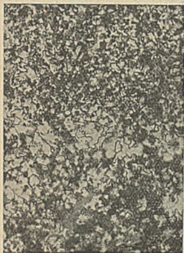
Rys. 19. Przejście od materiału rodzimego (stal 0,5% C), do warstwy napawanej drutem Tor. Powiększenie 200-krotne.
