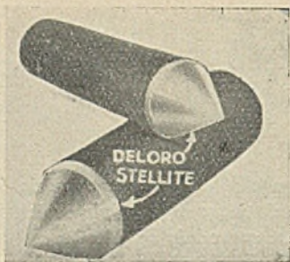
Rys. 101. Ostrza kłów tokarek nakładane twardym metalem mają powiększoną 6-krotnie trwałość na zużycie.
