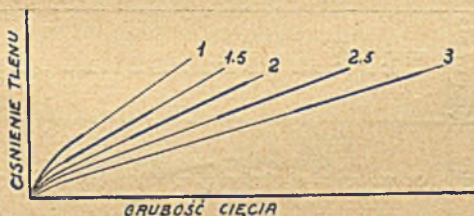
Rys. 9. Ciśnienie tlenu do cięcia w zależności od grubości materiału.
