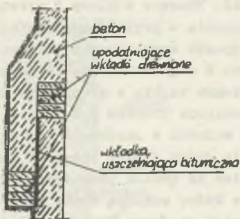
Rys. 4. Teleskopowa obudowa betonowa upodatniona, wkładkami drewnianymi
