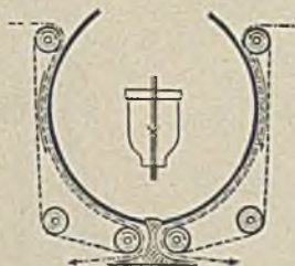
Abb. 6. Arbeitsschema der Lichtpausmaschine „Helios“.
