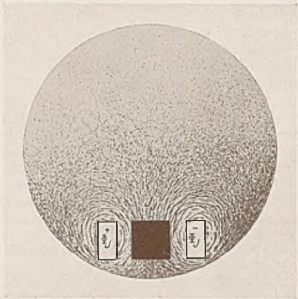
Abb. 22. Verlauf der durch \Phi_J induzierten Scheibenströme.
