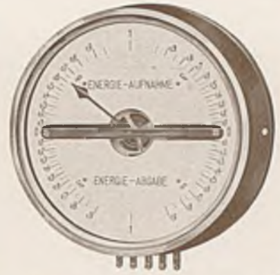
Abb. 15. Leistungsfaktormesser, 360° Ausschlag, geschlossen.
