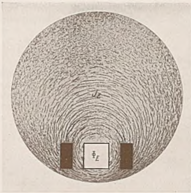
Abb. 21. Verlauf der durch \Phi_E induzierten Scheibenströme.
