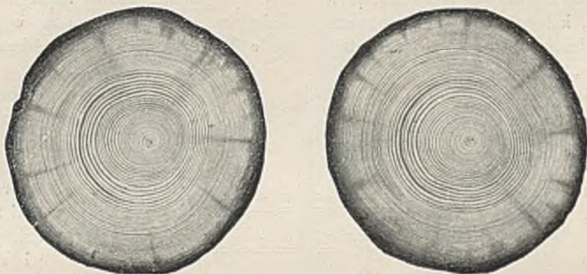
Sosna kyanizowana czyli drzewo nasycone masą impregacyjną tylko w otwartych naczyniach.
