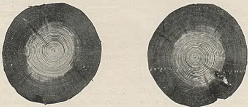
Sosna racjonalnie impregnowana za pomocą ciśnienia w kotle.
