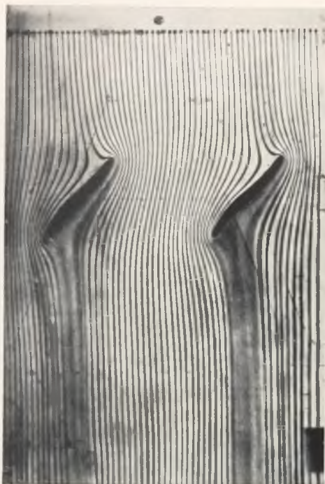
Abb. 86a Strömung durch das Gitter.
