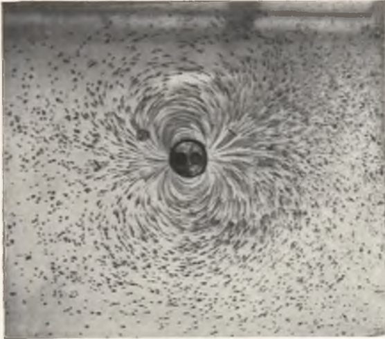
Abb. 44b. Hydrodynamisches Bild zu Netz III. — Doppelquelle.
