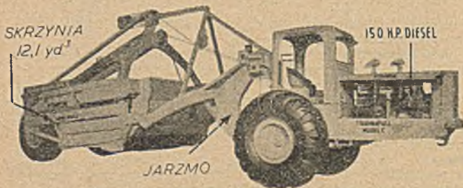
Zespół ciągnika model „C“ Tournapull i zbierak „L.P.“.
