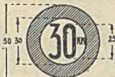
Zakaz przekroczenia określonej normy szybkości jazdy
