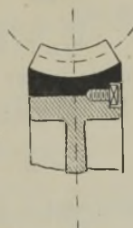
Befestigung des Schneckenradzahnkranzes am Radkörper.
