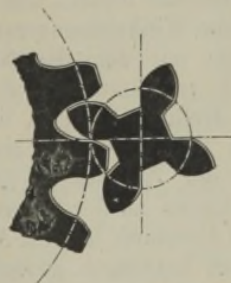
Zahnformen der Trieblinge für Wagenwinden.
