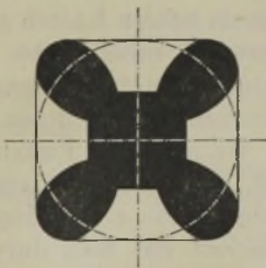
Zahnformen der Trieblinge für Wagenwinden.
