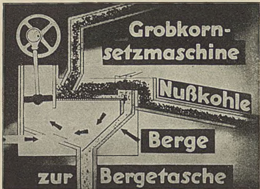
Abb. 8. Schnitt durch die Grobkorn-Setzmaschine.
