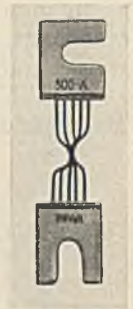
Abb. 46. Schmelzstreifen, der im Augenblick des Durchschmelzens ausgeschaltet wurde.
