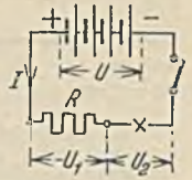
Abb. 7. Lampe mit Vorwiderstand.
