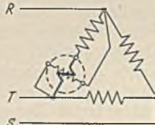
Abb. 156. Leistungsmessung bei Dreiecksschaltung (gleiche Strangbel.).
