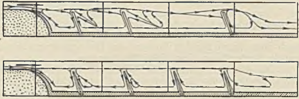
Abb. 160 u. 161. Wirbel im Buhnenfelde bei verschiedener Entfernung der Buhnen nach Engels.
