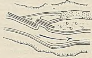
Abb. 148. Abschließung eines Nebenarmes zur allmählichen Verlandung mit Leitwerken.
