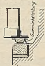
Abb. 580. Dichtung am Schleusendrempel. Maßstab 1:50.
