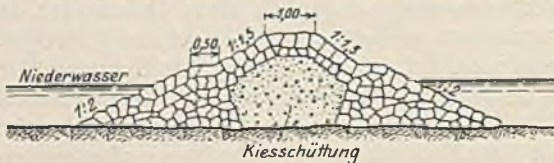
Abb. 180. Leitwerk am Main. Kern und Schale. Maßstab 1 : 150.
