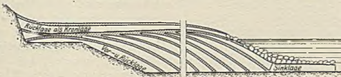
Abb. 171. Fertige Buhne mit Fußsicherung.
