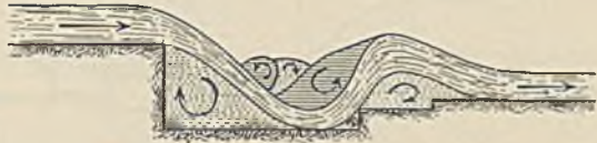
Abb. 319. Sturzwehr mit zwei Stoßnasen.
