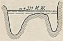
Abb. 22. Schlechte Ausbildung des Übergangs. Rhein bei Straßburg.
