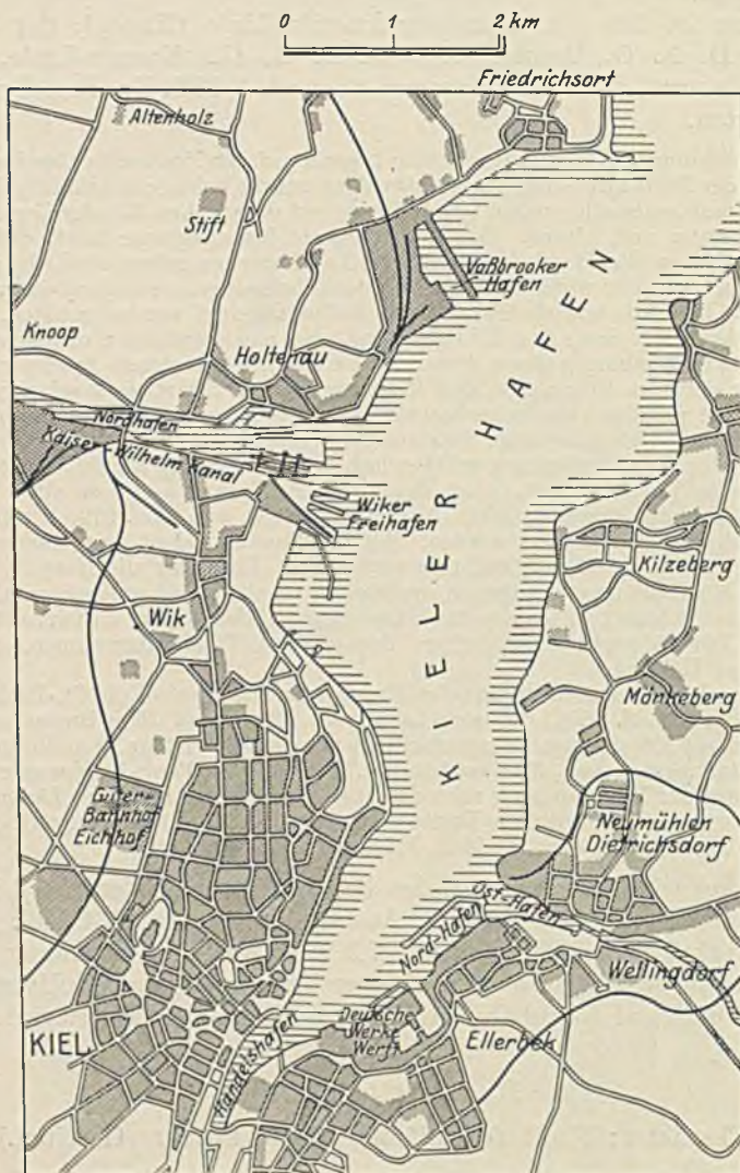
Abb. 980. Hafenanlagen in der Kieler Bucht. Küstenhafen. Geschützte Lage. Kleine Gezeiten. Früher Hauptbedeutung als Kriegshafen. Östlicher Ausgangspunkt des Kaiser-Wilhelm-Kanals. Hauptwindrichtung: Süd bis West. Maßstab 1 : 78 500.
