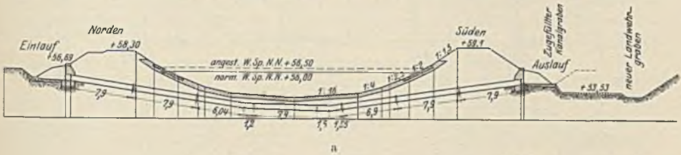
Abb. 736 a u. b. Düker bei Schulze-Wedeling. a Schnitt in der Achse, b Einlauf. Maßstab 1 : 650.
